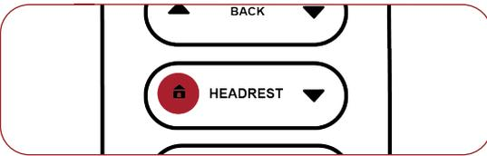
Pour remettre le siège en position verticale de départ, appuyez simplement sur le bouton HOME 🏠 et maintenez-le enfoncé jusqu'à ce que le fauteuil revienne à sa position de départ d'origine.
